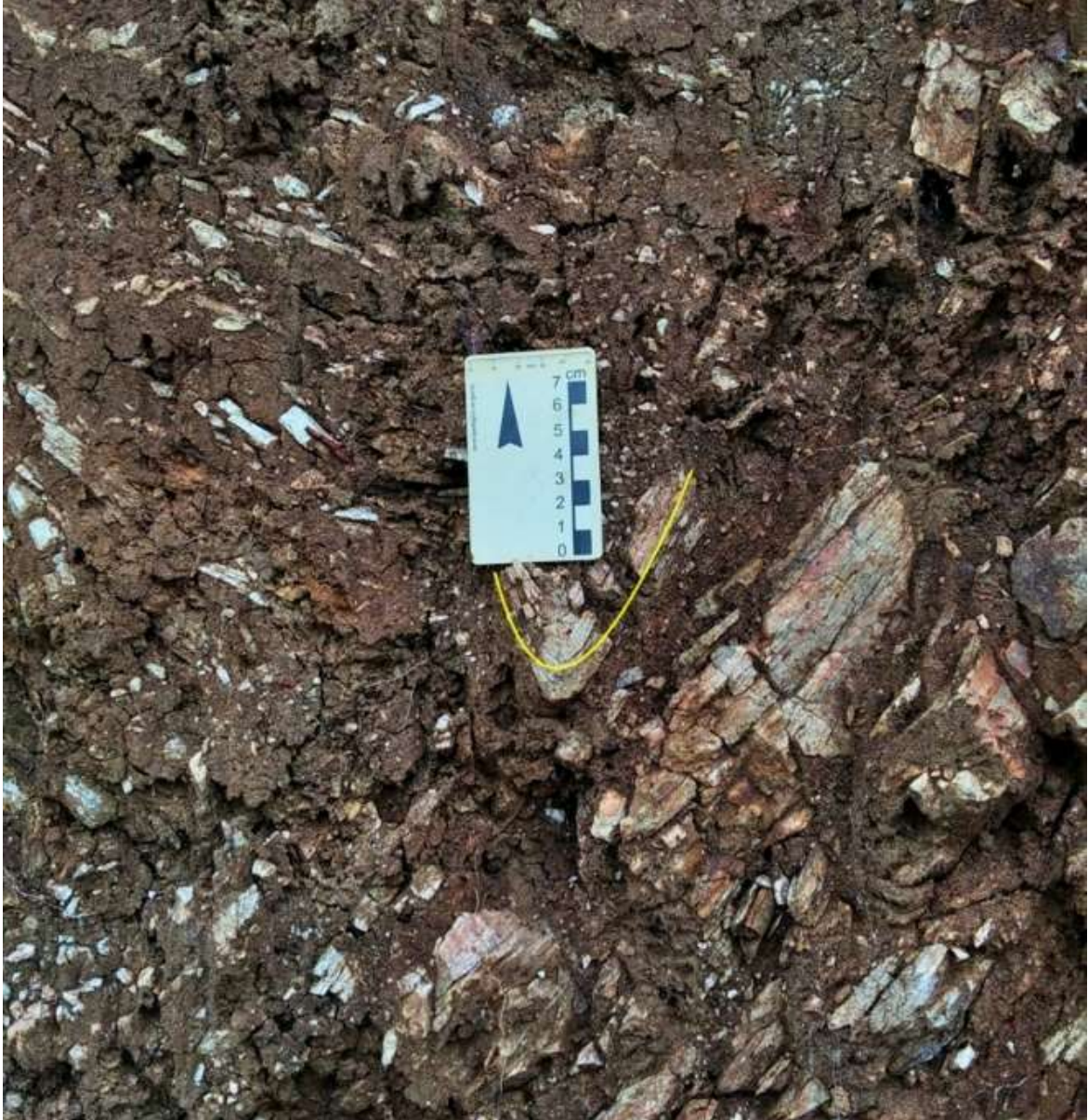
Figura 7 – Fragmento gnáissico exibindo dobramento geométrico sinforme, nas rochas do Complexo Santa Luz
