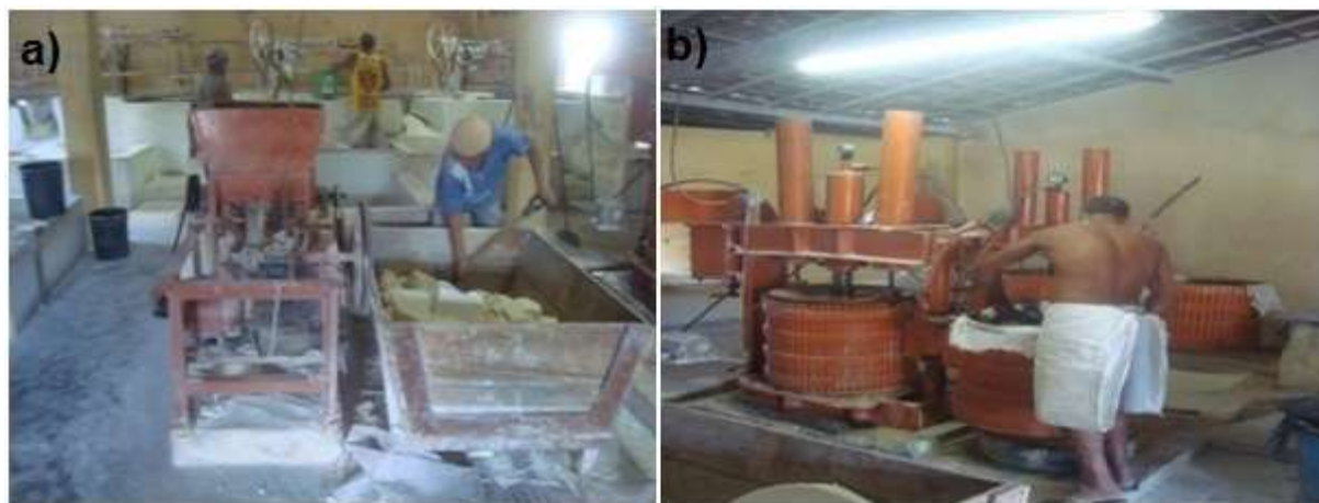
Figura 6 A - Trabalhador alimentando triturador com mandioca em casa de farinha nº. 11- Olho D’ Água dos Pombos- Lajedo; Figura 6 B - Prensa hidráulica em operação em casa de farinha nº. 11 - Olho D’ Água dos Pombos- Lajedo.
