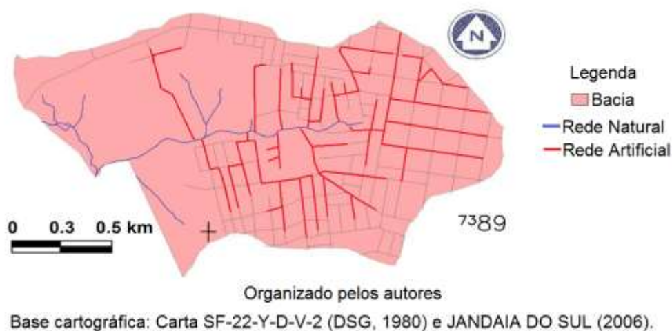
Figura15. Disposição espacial das galerias pluviais que desembocam no ribeirão Cambará. Obs: os trechos em vermelho se referem as galerias pluvias que drenam a área urbanizada ao entorno dos trechos fluviais estudados
