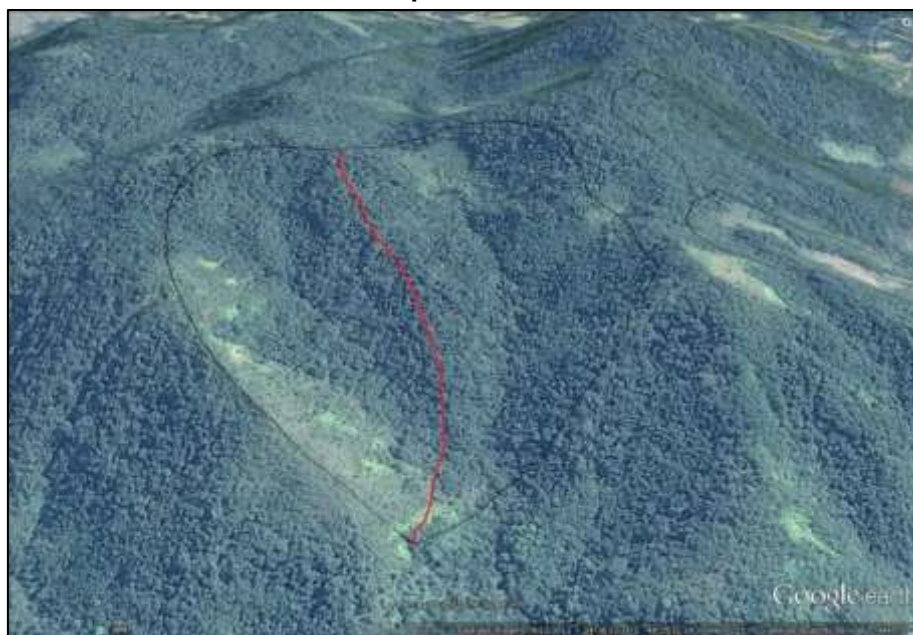
Figura 4 – Falsa bacia de primeira ordem. A linha preta representa a bacia mapeada pela base planialtimétrica e linha vermelha indica um divisor de águas no interior dessa bacia dita de primeira ordem.
