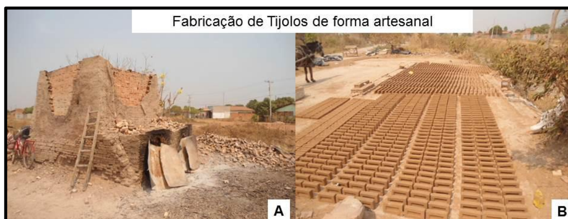
Figura 04- Fabricação de tijolos de forma artesanal Canal dos Fontes.
