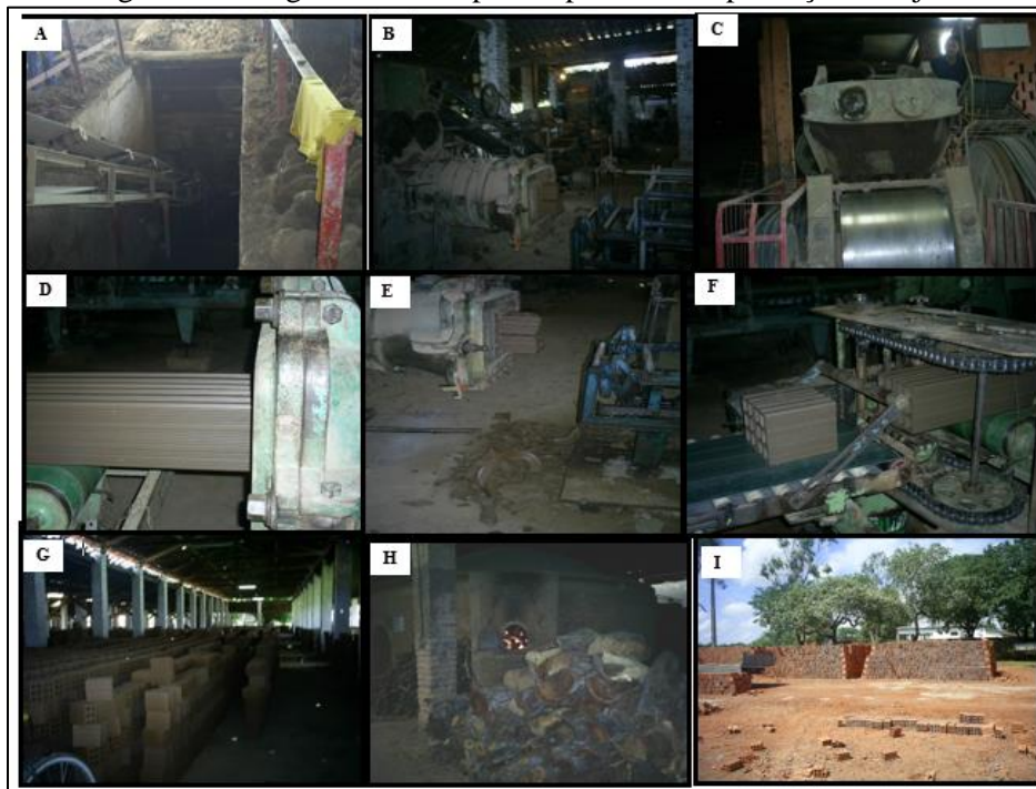
Figura 2 - Fotografias das etapas do processo de produção do tijolo
