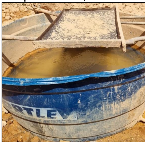
Figura 7 - Caixa de água utilizada para lavagem do rejeito no garimpo Boi Morto, município de Pedro II, estado do Piauí
